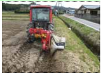
畦塗り機により溝畔を補強します。作業は3月中下旬から4月上旬が適しています。
