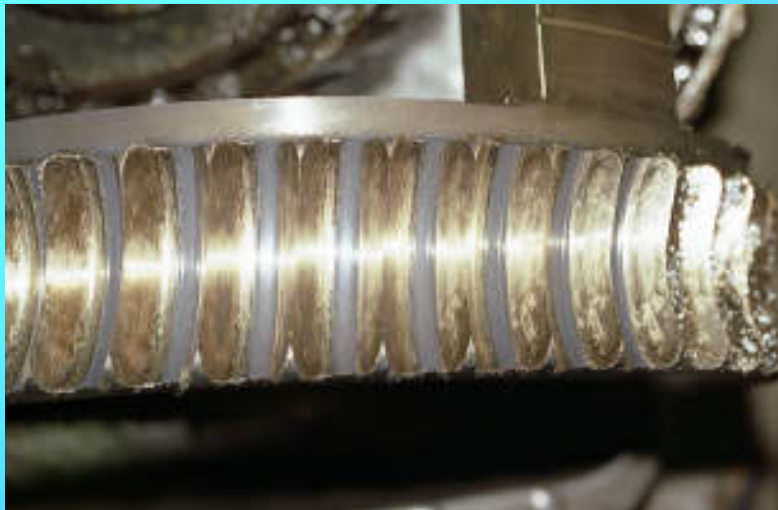
ウォームホイール旧品の状態 (歯面がナイフエッジ状に摩耗している)
