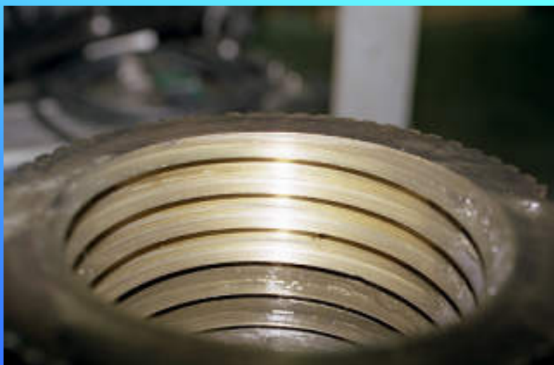
メネジ旧品の状態 (歯面がナイフエッジ状に摩耗している)
