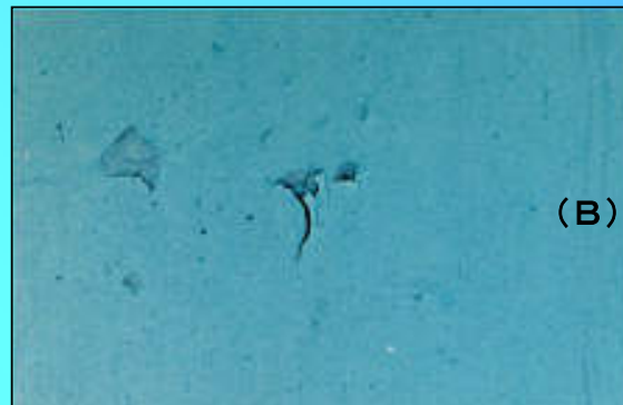
劣化標準写真（はくり）
