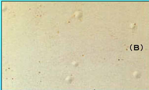
劣化標準写真（ふくれ）
