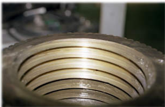
メネジ旧品の状態 (歯面がナイフエッジ状に摩耗している)
